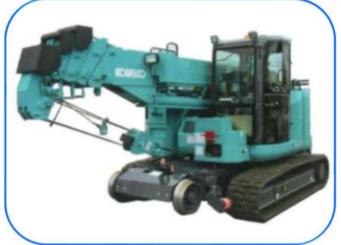
■ 4.9 t クローラークレーン
